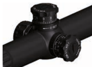
TORRETTE MAGGIORATE CON SCALA A VISTA E DOTATE DI REGOLAZIONI DA 1/8 DI MOA CON POSSIBILITÀ DI FISSARE IL PUNTO ZERO (TATTICO)
